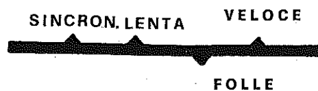
Schema velocità presa di forza indipendente
