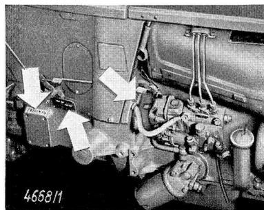
Sie finden diese Angaben auf dem Typenschild und eingeschlagen am Motor- und Kupplungsgehäuse. **Die Daten müssen mit den Eintragungen im Kraftfahrzeugbrief übereinstimmen.**
