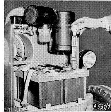
**Batterie:** Die elektrische Anlage muß immer in einem guten Zustand sein. Bei Arbeiten an der elektrischen Anlage sind zur Vermeidung von Kurzschlüssen die Batteriepole abzuklemmen. Die Flüssigkeitsverluste in den Batterien infolge Gasentwicklung und Verdunstung sind alle 100 Betriebsstunden durch destilliertes Wasser zu ergänzen, niemals durch Säure. Hierbei stets sauberes Gefäß verwenden.
