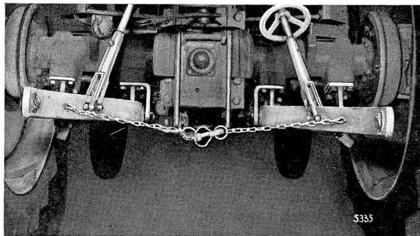
4. Gerät hydraulisch ausheben, wobei die Motordrehzahl zu steigern ist. Schalthebel in „0-Stellung“ legen, **Gerät nach jedem Transport vor Stillsetzen des Motors ablassen.** Unfallverhütung! (siehe Seite 52).
