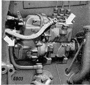
Bei jedem Ölwechsel ist die Kontrollstandschraube am Reglerdeckel herauszuschrauben und überschüssiges Öl-Kraftstoffgemisch abzulassen. Tritt kein Ölgemisch heraus, so ist frisches Motorenöl durch den Einfüllstutzen an der Einspritzpumpe zu ergänzen.
