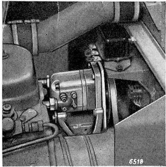
Als Ölpumpe wird eine Bosch-Zahnradpumpe mit Vorsatzlager verwendet, die mittels eines Keilriemens von der Motor-kurbelwelle angetrieben wird. Die Pumpe arbeitet dadurch unabhängig von der Fahrkupplung des Schleppers.
