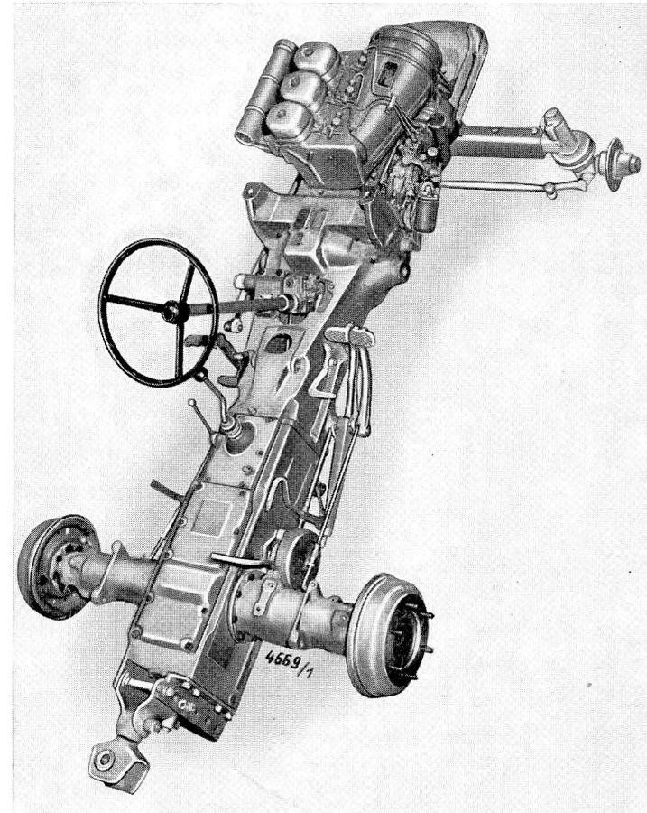
Der Schlepper ist in Blockbauart ausgeführt, d. h. Vorderachslagerbock, Motor und Getriebe sind unmittelbar miteinander verflanscht und bilden das Trag-
