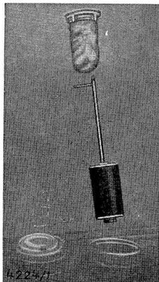
Zur Reinigung wird der Filzrohreinsetz nach Einstecken der sich beim Werkzeug befindlichen Reinigungsvorrichtung in die untere Öffnung in Dieselloch oder Petroleum getaucht und mit einer weichen nicht metallischen Bürste abgebürstet. Dabei darauf achten, daß die Reinigungsflüssigkeit nur durch den Filz des Einsatzes und nicht durch den Schlauch in das Innere gelangen kann.
