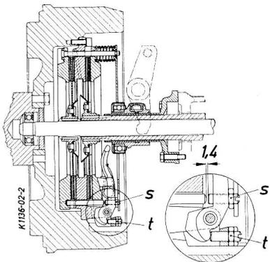
Das Kupplungsgehäuse nimmt die Lenkung auf und umschließt das Schwungrad des Motors mit der Doppelkupplung, die von einem Fußhebel über einen Kugellagerausrücker betätigt wird.
