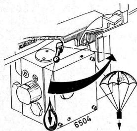
Die **Reaktionsgeschwindigkeit** des Arbeitsgerätes (Pflug) während der Fahrt durch weiche oder leichte Bodenstellen kann durch die **Senkdrossel** „D“ beeinflusst werden.
