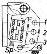
Die **Ansprech-Empfindlichkeit** der Regelungen kann durch Einstecken des oberen Lenkers in die verschiedenen Bohrungen des **Gebers** „G“ verändert werden.
