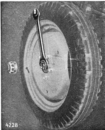
**Vorderradlagerung.** Die Kegelrollenlager müssen von Zeit zu Zeit auf spielfreien Lauf geprüft und rechtzeitig nachgestellt werden. Hierzu ist das betreffende Rad hochzubocken und nach Abnahme der Radkappe der Splint zu entfernen und die Kronenmutter nachzuziehen, bis sich das Rad spielfrei drehen läßt. Zur Vermeidung von Spannungen wird die Mutter wieder um eine Viertelumdrehung gelockert und dann versplintet.
