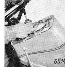
**Vorglühen:** Knopf des Glüh-anlaß-Zugschalters bis zum spürbaren Widerstand herausziehen. Aufleuchten des Glühüberwachers beobachten. (Vorglühen ca. 15–20 Sekunden). Bei kaltem Motor etwa 1 Minute lang vorglühen, bei betriebswarmem Motor ist das Vorglühen nicht erforderlich. Dann den Knopf weiter herausziehen. Hierbei tritt der Anlasser in Tätigkeit. **Sobald der Motor zündet, Knopf loslassen.** (Max. Betätigung des Anlassers 15 Sekunden.) Zum „Nachglühen“ Knopf bis 1. Raste herausziehen.
