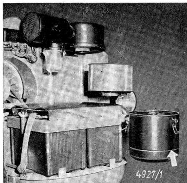
Ist Öl dunkel oder eingedickt, wobei der Ölstand nur wenig ansteigt (ca. +5 mm) Öltopf auswaschen und mit frischem Motorenöl bis Unterkante Ölstandmarkierung füllen. Ölfüllung jahreszeitlich wie beim Motor.
