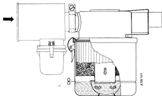
Die vom Motor angesaugte Luft wird durch ein unter der Motorhaube sitzendes Ölspülluftfilter geleitet und dadurch entstaubt.
