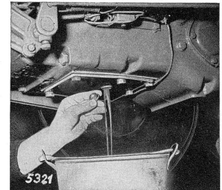
Der Ölwechsel wird zweckmäßig unmittelbar nach der Arbeit durchgeführt, wenn das Triebwerk noch warm ist und das Öl leicht abfließt.
