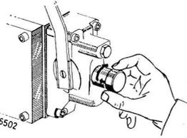
Durch feinfühliges Betätigen des Steuerhebels H2 kann das Heben oder Senken des Zusatz-Zylinders von langsam bis schnell geregelt werden. Beim Heben des **Frontladers** beispielsweise ist volle Drehzahl und schnelles Schalten aufwärts, beim Senken (vorzugsweise mit Last) Drehzahl-Verminderung und langsames Abwärtschalten zu empfehlen. Die Motordrehzahl-Variation erfordert ein Fahren mit der Fuß-Drehzahlverstellung.
