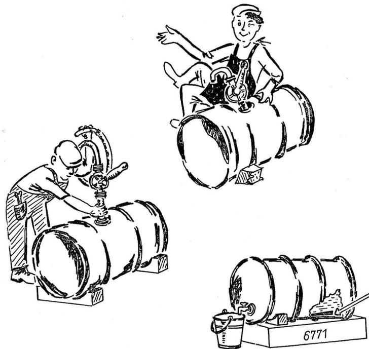
Der Kraftstoff muß frei von Sand, Schlamm und Wasser sein, da sonst Einspritzpumpe und Einspritzventil verschmutzen und vorzeitiger Verschleiß verursacht wird. Verzinkte Fässer sind als Lagerbehälter nach Möglichkeit wegen chemischer Einwirkung nicht zu verwenden.
